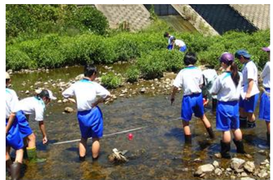
流量計算のための流速測定
